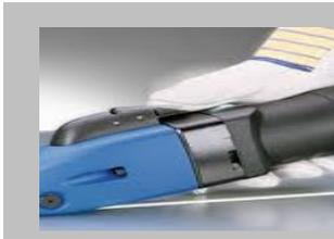
Per le cesoie mobili (elettriche, ad aria o manuali) mantenere una corretta postura, in equilibrio e stabilità, al fine di contrastare eventuali contraccolpi e blocchi per le cesoie mobili. Impugnare saldamente l'utensile e attenersi rigorosamente a quanto descritto nel rispettivo manuale d'uso e di manutenzione. E' assolutamente vietato cesoiare materiali utilizzando i piedi o una mano come metodo di bloccaggio.
